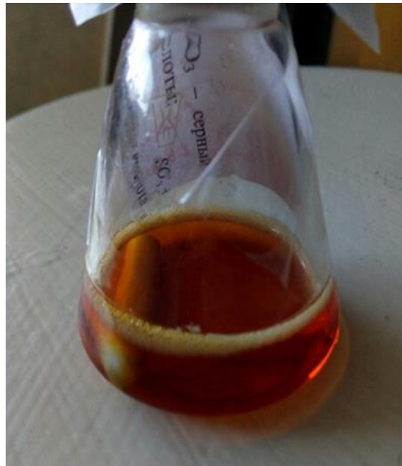
Рисунок 39 – Синтез наночастиц селена из диацетофенонилселенида при температуре 25°C в среде TWEEN 80 под воздействием аммиака через 7 суток
