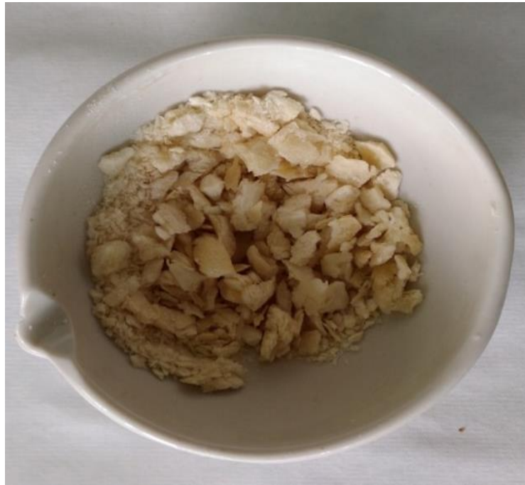
Рисунок 19 – Порошок адсорбированных на хитозане наночастиц селена до измельчения
